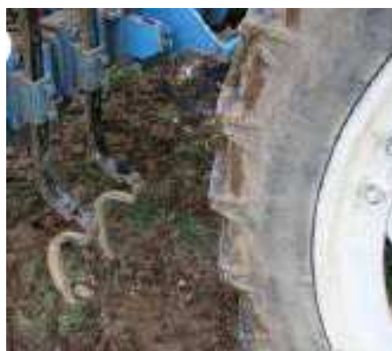
Exemple avec semoir à céréales, les effaceurs se trouvent juste derrière la roue de tracteur
