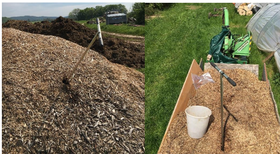
Figure 7 : Prélèvement du BRF grâce à une tarière dans un andain (à gauche) et dans une remorque (à droite).
