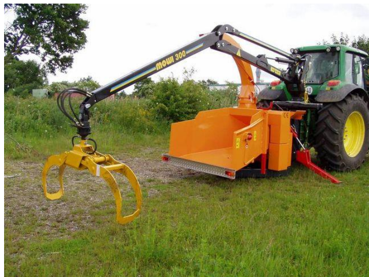
Figure 4 : Broyeur sur prise de force de moyenne capacité. ( https://www.public-expo.fr ).
