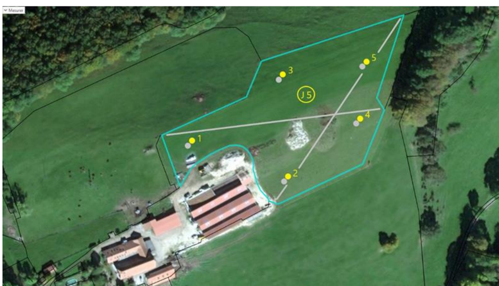
Annexe 12: Localisation des sondages à la tarière (points jaunes) pour la caractérisation des sols et analyses effectuées par nos soins (prélèvements composites pour analyses de sols : traits gris et prélèvements pour les analyses de densité apparente de la terre fine : points gris) chez Joan Studer.
