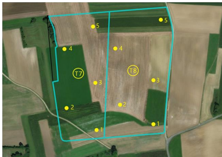
Annexe 11 : Localisation des sondages à la tarière (points jaunes) pour la caractérisation des sols et analyses effectuées par nos soins (prélèvements composites pour analyses de sols : traits gris et prélèvements pour les analyses de densité apparente de la terre fine : points gris) chez Thomas Vuillaume.
