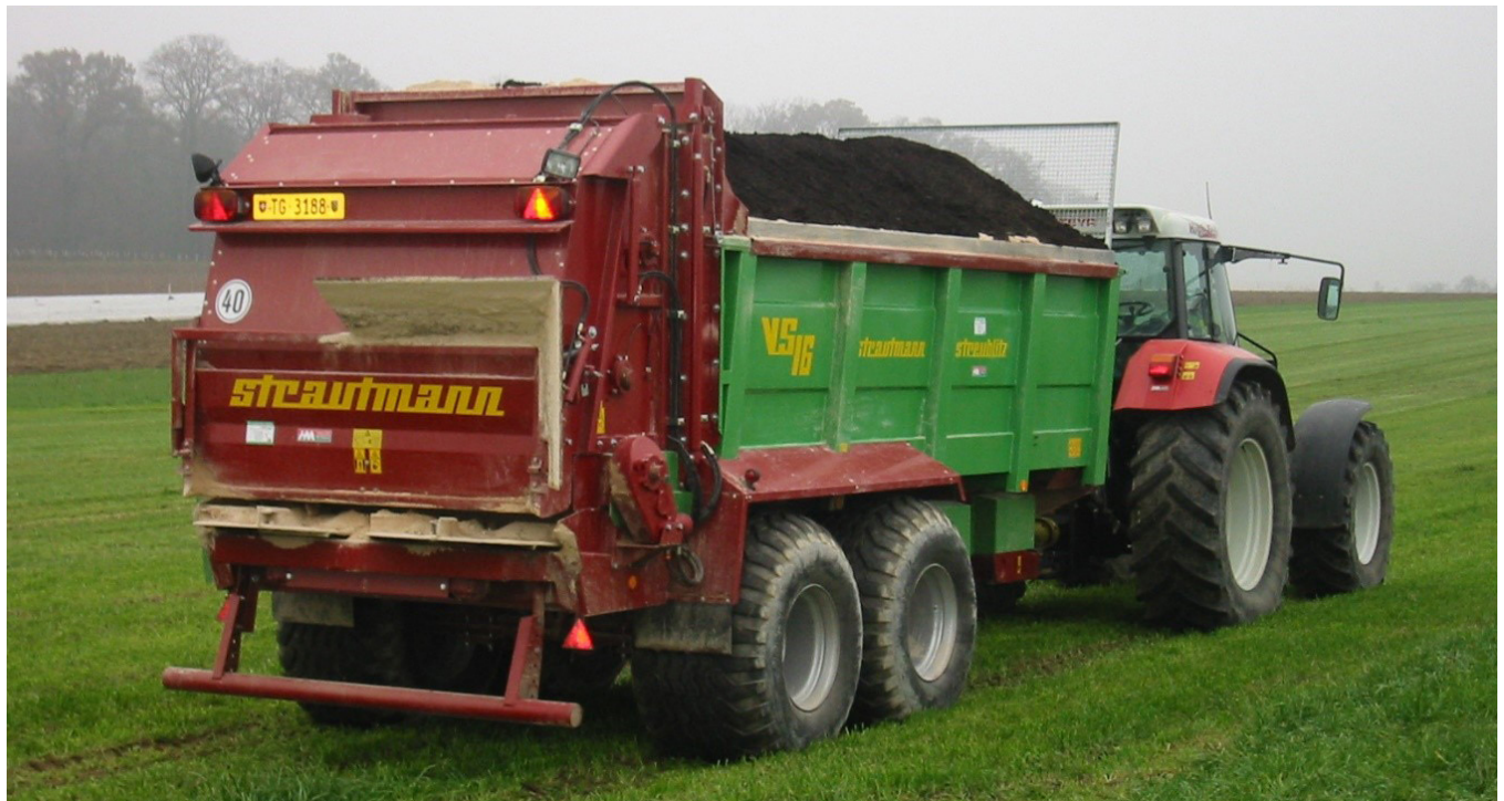
Festes Gärgut wird am besten mit Kompoststreuern mit Möglichkeit zur Regulierung des Reifendrucks ausgebracht
