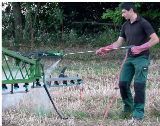
Lavage au champ de la rampe du pulvérisateur
