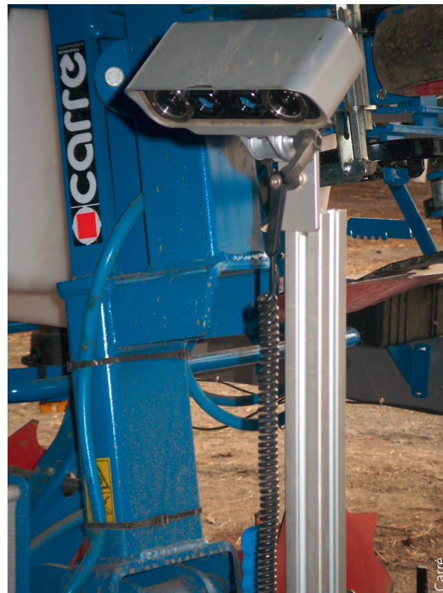
Sarclage de céréales guidé par caméra
